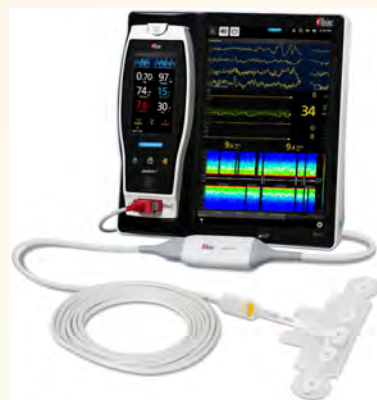
▲圖1：麻醉深度監控裝置 (出處：Masimo Corporation，邁心諾公司)
