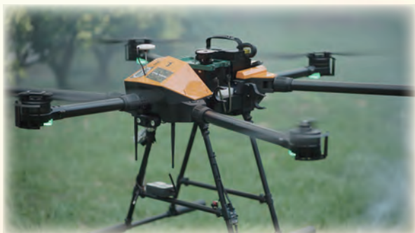
▲無人機結合空氣生物微浮質即時偵檢採樣系統
