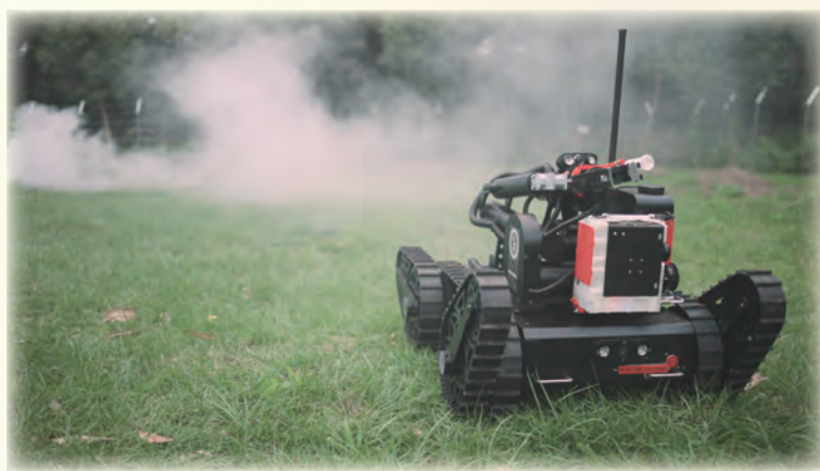
▲機械手臂結合空氣生物微浮質即時偵檢採樣系統
