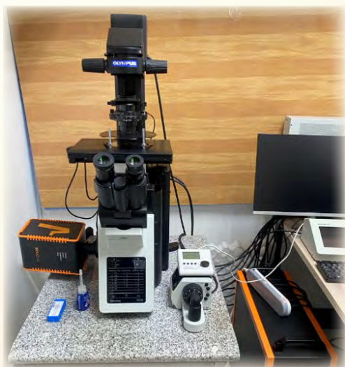
▲圖八：超高解析共軛焦顯微鏡擷取外泌體生物標的清晰影像
