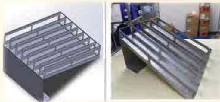
▲圖2：設計出「管灌配方架」，利用簡單重力原理，將物品墊高產生溜滑梯效果
